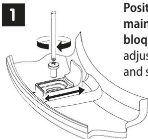
**Positionner la cale de maintien et visser pour bloquer la cale / Place and adjust the blocked buffer and screw to block it**
