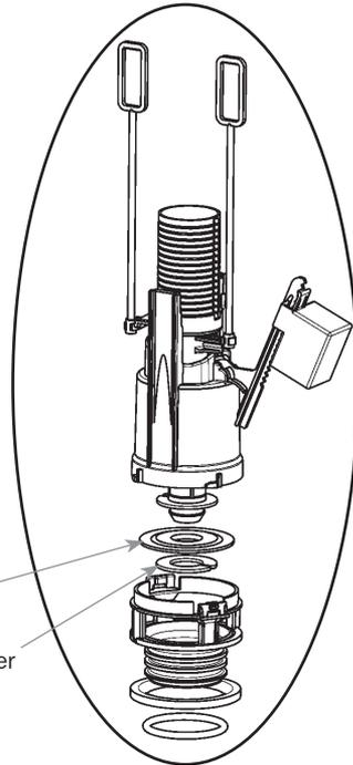
③ Désolidariser le corps du mécanisme de la bonde en faisant pivoter cette dernière. Déclipser la rondelle, sortir le joint d'étanchéité et le remplacer puis remonter le tout. Une fois l'entretien terminé refaire toutes les étapes en sens inverse.
