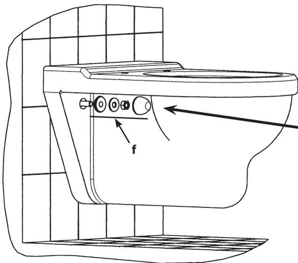
Une fois la cuvette correctement positionnée, la fixer à l'aide du kit (f) en respectant l'ordre d'empilage des pièces :
