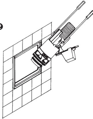
② En saisissant le mécanisme par sa base le retirer du réservoir
