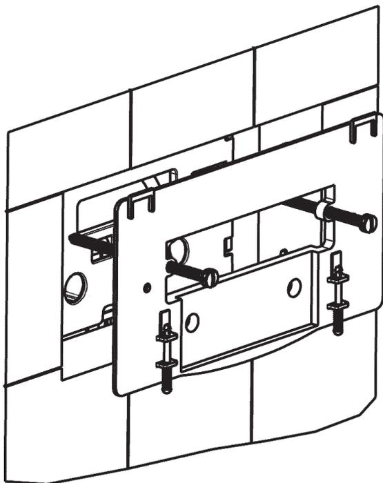
1 Fixer le châssis de la plaque de commande sur le cadre à l'aide de 2 vis grises.
