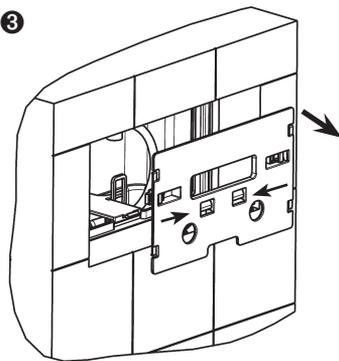
1 Retirer la plaque de commande en la soulevant légèrement et en la basculant vers l'avant, dévisser les vis d'actionnement
