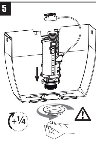
NB : Un serrage excessif peut entraîner une détérioration du mécanisme qui ne serait pas couverte par la garantie.
