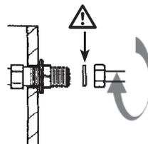
NB : Un serrage excessif peut entrainer une deterioration du robinet qui ne serait pas couverte par la garantie.
